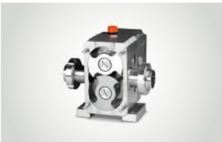
POMAC – Pompe a lobi Pompe a lobi in acciaio AISI 316 adatte a fluidi viscosi e abrasivi; trovano applicazione nel settore chimico, alimentare e farmaceutico.
