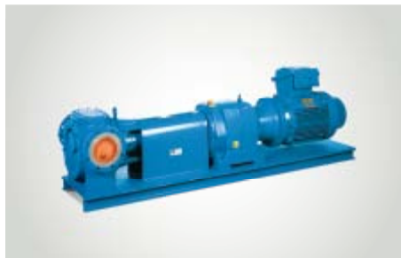
TUTHILL – Pompe ad ingranaggi Pompe ad ingranaggi conformi alle normative API 676 per alte viscosità; disponibili con una struttura volumetrica a ingranaggi interni e pistoni circonferenziali, gestiscono con efficacia le applicazioni di processo più impegnative.
